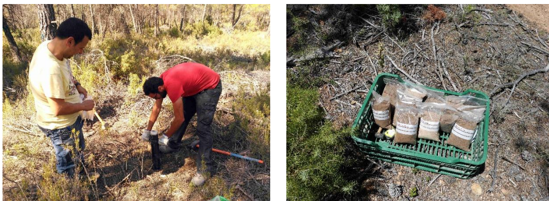
Imagen 3. Toma de muestras de suelo en masas forestales gestionadas de la Región de Murcia mediante barrenas (izquierda) y preparación para su posterior tratamiento y análisis en laboratorio (derecha)
